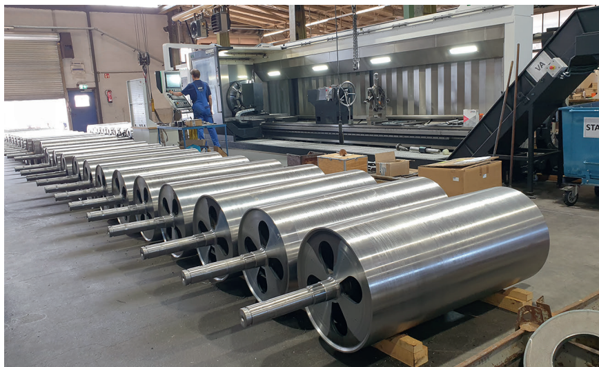
2 Viele Kunden von MBM kommen aus der Kunststoffindustrie. Für sie werden beheizbare Walzen gefertigt, die man zur Herstellung von Plastikfolien benötigt © Ingersoll Werkzeuge
